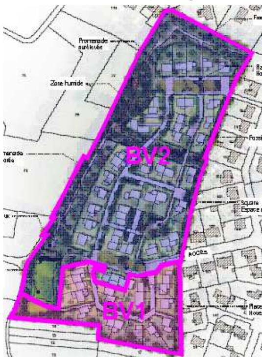
Au vu de la topographie générale du terrain et de l'aménagement prévu, et afin de limiter la profondeur des bassins de rétention, le projet a été divisé en deux bassins versants distincts permettant de créer deux bassins de rétention avec des profondeurs limitées.
