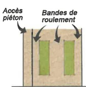
Structures alvéolées avec gravillons sur les bandes de roulement et accès piéton enherbées ailleurs
